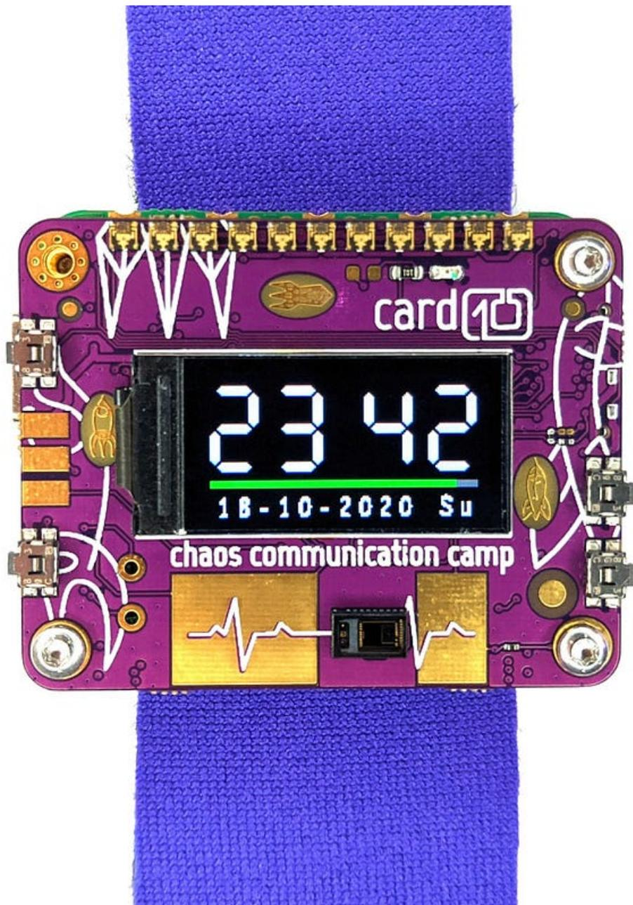
Figure 5: CCC2019—Card10 orologio da polso con cardiofrequenzimetro
